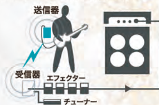
図2 ▼ペダルワイアレスセッティング例
